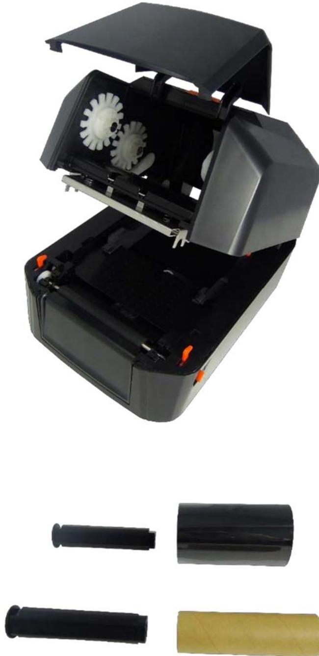
0.5 英寸管芯碳带：打开上盖并开启碳带掀盖，将 0.5 吋芯专用帽盖装在上内盖右侧。
