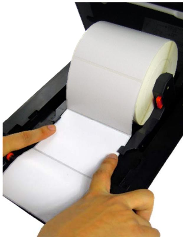
2)将标签纸拉过橡胶滚轮后并压放入两侧导纸夹内，安装完成盖上上盖。
