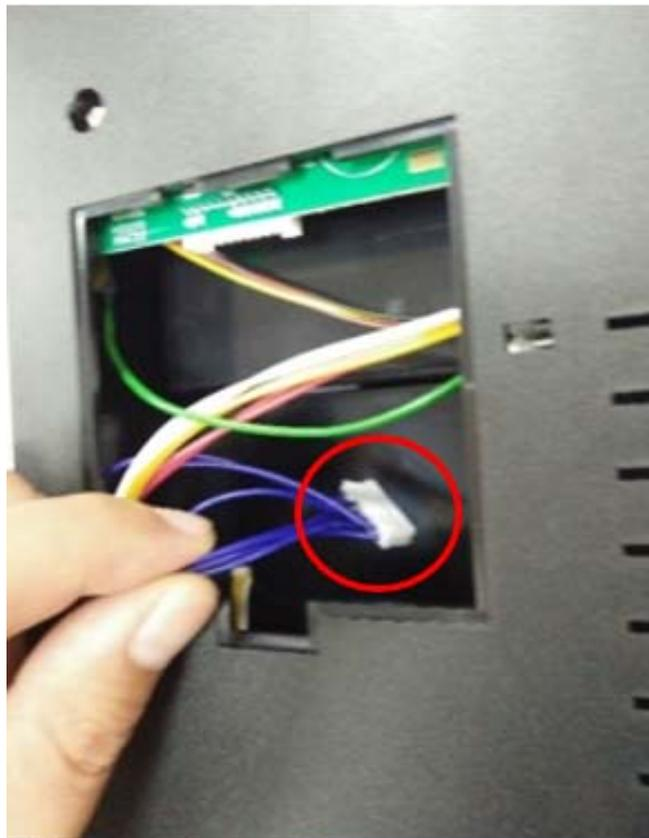
6)将连接线装至于主板上，完成后盖上下底盖。
