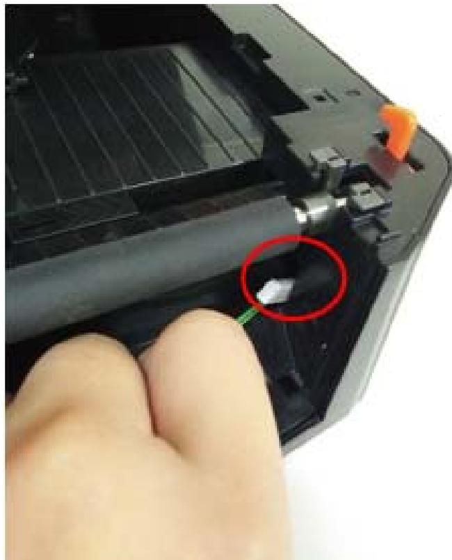
4)将模块两侧确实嵌进下内盖左右两侧的孔洞内。
