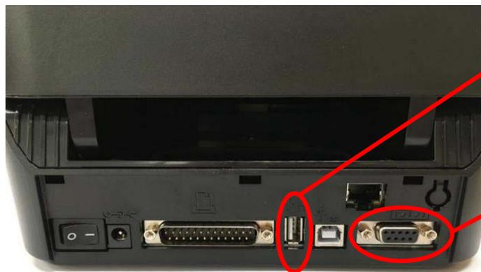
USB Host 主端接口，用来连接 USB 键盘、USB 扫描枪与 USB 电子秤
