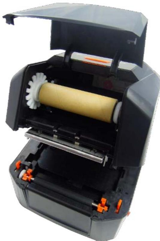
4)将碳带绕过印字头，黏贴在回收纸筒上并保持平整，旋转转盘使碳带没有任何褶皱，关上上盖。
