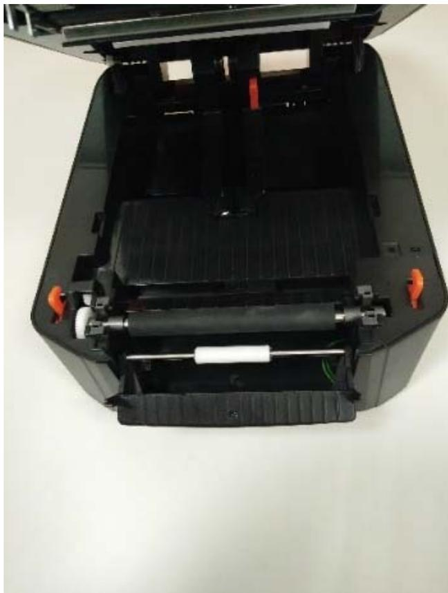
5)将弹簧装上铁件的右侧，然后将铁件右侧的箭头朝前，安装在下内盖。
