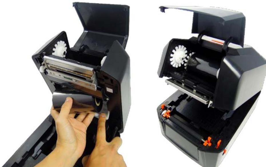
3)将回收纸筒插入碳带回收轴(圆形轴头向左), 先从右侧压入再从左侧装入, 请注意将回收纸筒左侧的凹槽需与碳带机构左侧轴心的凸起部分相结合才能顺利使用。
