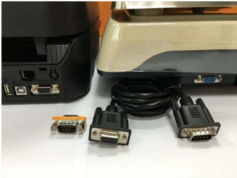
2) 再来电子秤透过数据线再透过公母跳线转换头与打印机连接。
